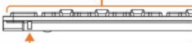
● **LED** Pendant la connexion à un ordinateur ou tablette, le LED va clignoter. Une fois le Xkey reconnu et prêt à être utilisé, le LED sera allumé
