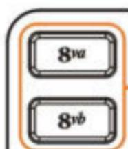
**Oktaaf +/-** Druk de twee toetsen gelijktijdig in om het toestel te resetten naar de standaard octaaf instelling. Om terug te keren naar de standaard fabrieksinstelling, dient u de twee toetsen ingedrukt te houden en tegelijk het toestel met uw computer te verbinden.
