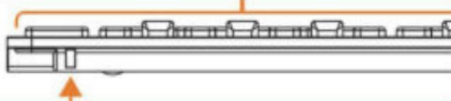
● **LED** Светодиод мигает при обнаружении устройства компьютером. Светодиод горит при стандартной работе устройства.
