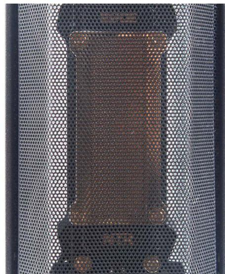
*Das Herzstück des NTR ist eine präzisionsgefertigte Bändchen-Kapsel, die mit einer hauchdünnen Spezialmembran aus Reinaluminium und schwingungssicherer Aufhängung aufwartet.*
