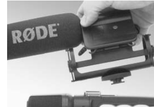
Abb. 5 – Montage des VideoMic an die Kamera
