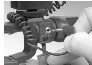
Abb. 6 – Anschluss des Klinkensteckers
