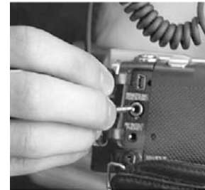
Abb. 6 – Anschluss des Klinkensteckers
