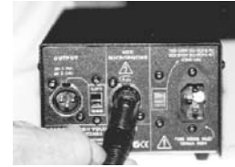
Abb. 2 – Anschluss des NTK mit beiliegendem Anschlusskabel
