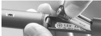
Abb. 1 und 2 – Einlegen der Batterie
