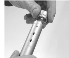
Abb. 5 – Wechseln der Kapsel
