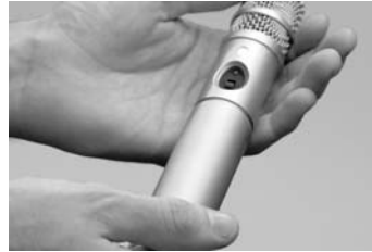
Abb. 1 – Aufschrauben des Gehäuses
